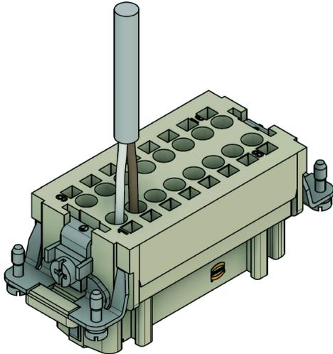
1. Anstatt die Kommunikationsleitung des Wechselrichters direkt auf Pin 1/2 aufzulegen, wie in Kapitel 6.3.8 (der Montage- und Serviceanleitung von Home 10 und Home 20 & 30) beschrieben, muss auf Pin 1/2 die Kommunikationsleitung zum Zähler angeschlossen werden.
