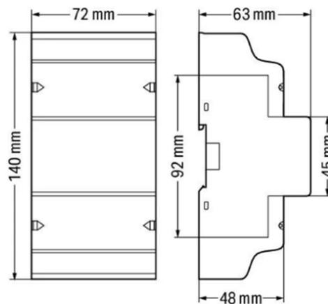
Abbildung 2. Abmessungen
