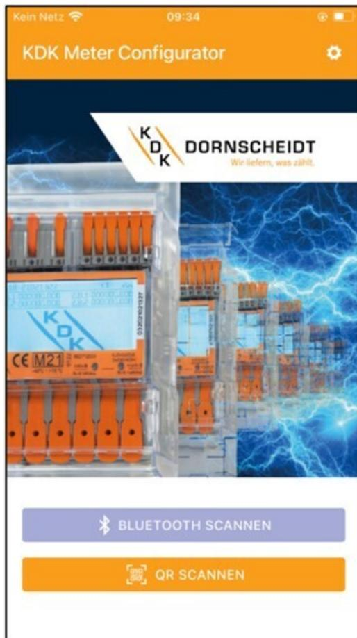
Alle Push-in-CAGE CLAMP® Zähler sind in der Lage, per Bluetooth® ausgelesen und konfiguriert zu werden. Der verwendete Standard ist BLE 4.2. Sie können die Smartphone-App für Android und IOS kostenlos in den jeweiligen Stores herunterladen. Die Smartphone-App finden Sie unter dem Namen "KDK Meter Configurator".
