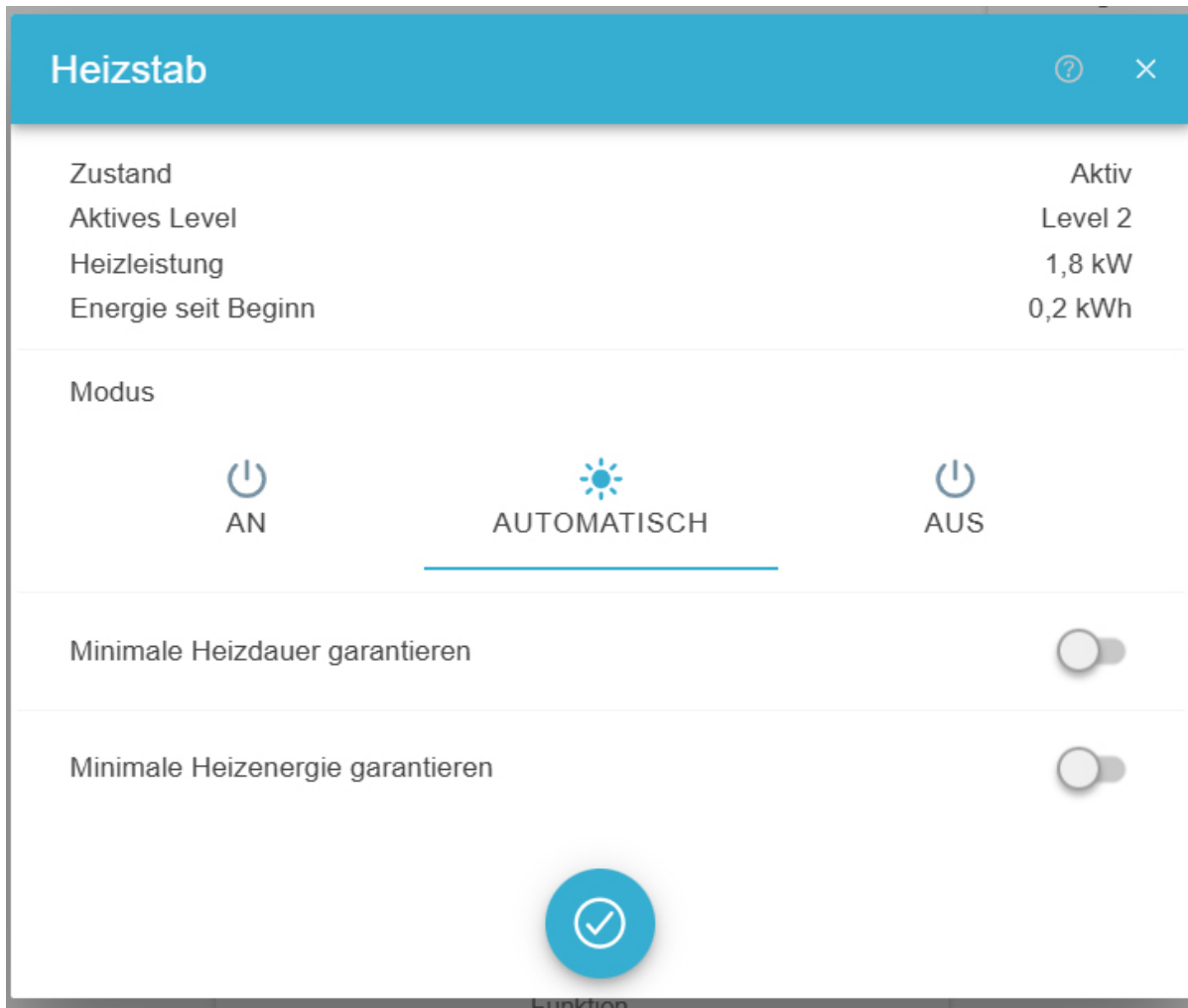
Abbildung 12. Heizstab — Betriebsmodus "Automatisch"
