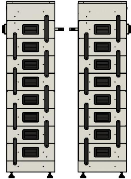
16. Mit den mitgelieferten M4-Schrauben die Befestigungsschienen auf beiden Seiten des Batteriemodul-Stapels befestigen.
