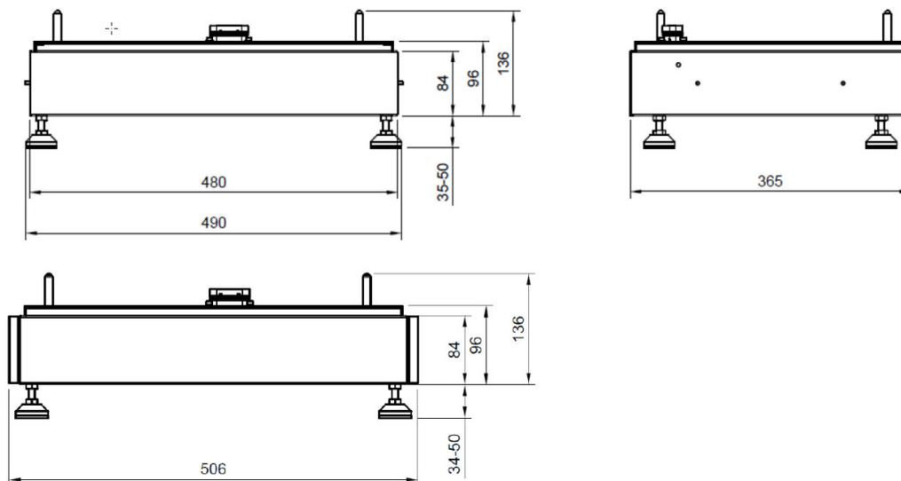
Abbildung 9. Abmessungen - Sockel
