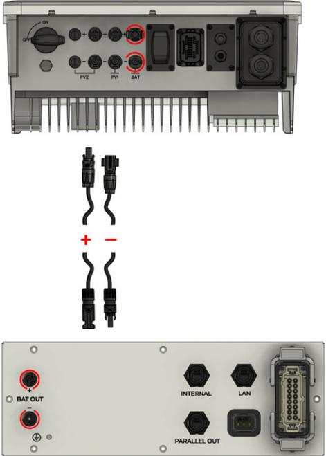
1. Das beiliegende 1,5m DC-Kabel für die Verbindung von Batterieturm und Wechselrichter verwenden.
