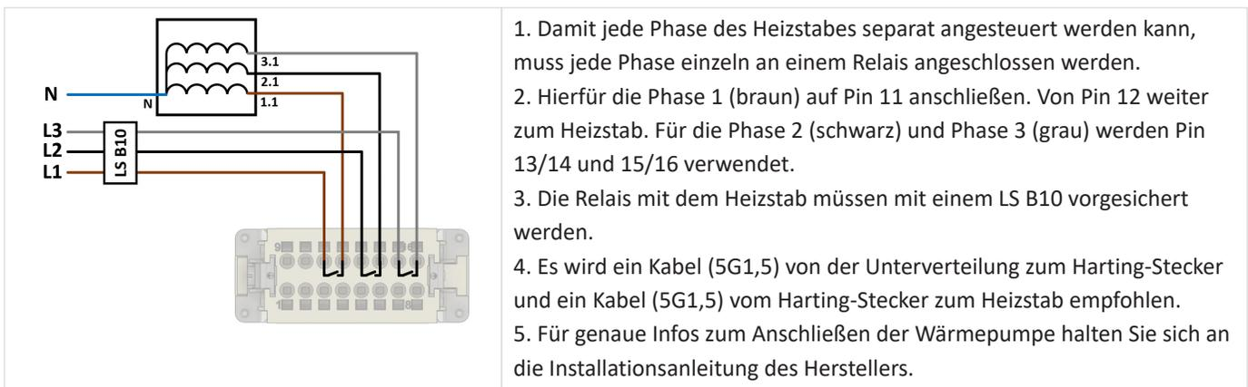
1. Damit jede Phase des Heizstabes separat angesteuert werden kann, muss jede Phase einzeln an einem Relais angeschlossen werden.
