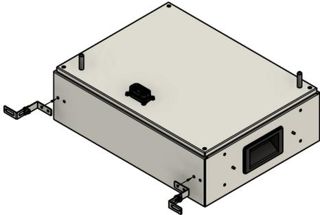
10. Die Winkel mit den beiliegenden M4-Schrauben an der Symphon-E - BMS-Box anbringen.
