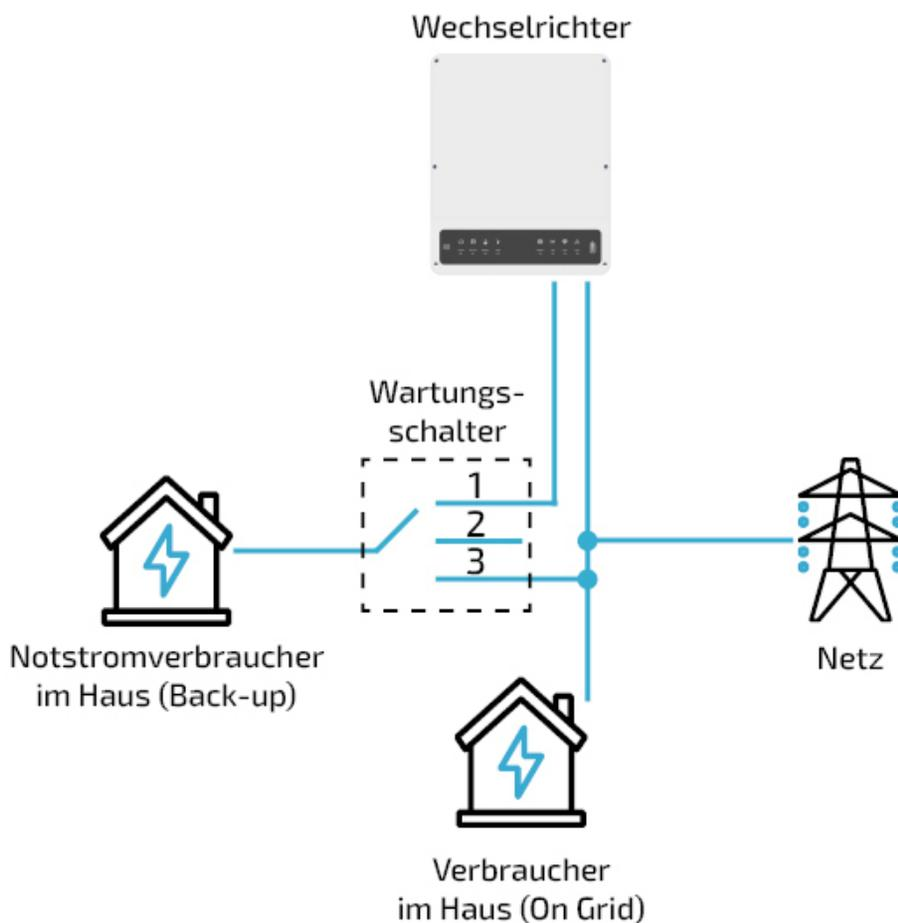
Abbildung 23. Empfohlener Wartungsschalter für Notstromabgang
