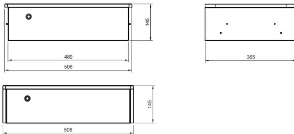
Abbildung 2. Abmessungen - EMS-Box
