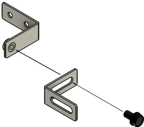
9. Mit den Schrauben M6 die beiden Winkel für die Wandhalterung zusammenbauen.
