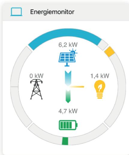
11. Nach Abschluss der IBN ist das System betriebsbereit und sie werden direkt zum Live-Monitoring weitergeleitet.
