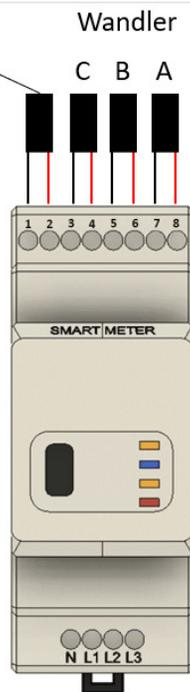
14. Spannungsabgriff an den markierten Anschlüssen vom Energy-Meter anschließen.
