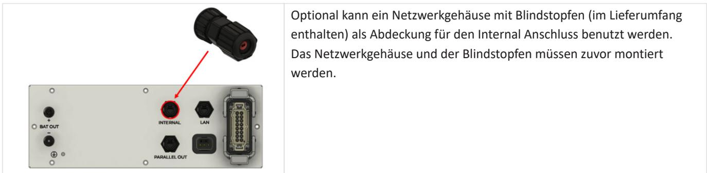
Optional kann ein Netzwerkgehäuse mit Blindstopfen (im Lieferumfang enthalten) als Abdeckung für den Internal Anschluss benutzt werden. Das Netzwerkgehäuse und der Blindstopfen müssen zuvor montiert werden.
