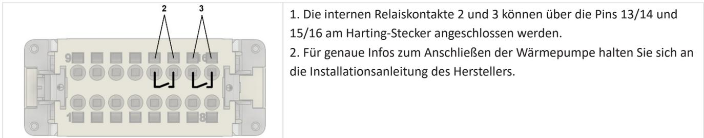
1. Die internen Relaiskontakte 2 und 3 können über die Pins 13/14 und 15/16 am Harting-Stecker angeschlossen werden.
