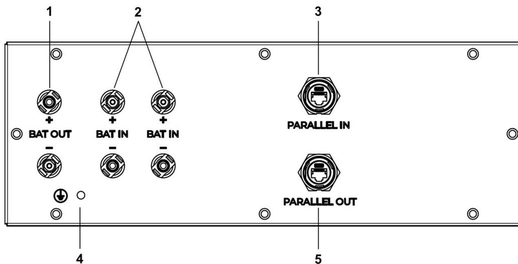
Abbildung 5. Anschlussbelegung - Parallel-Box
