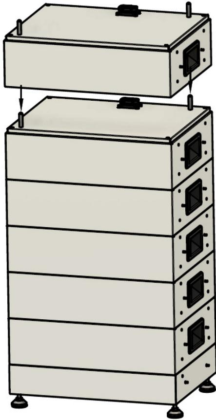
8. Alle restlichen Symphon-E - Batteriemodule auf die gleiche Weise montieren.
