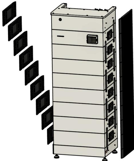
18. Die Seitenblenden des Sockels, der Batteriemodule, der BMS-Box und der EMS-Box einsetzen.
