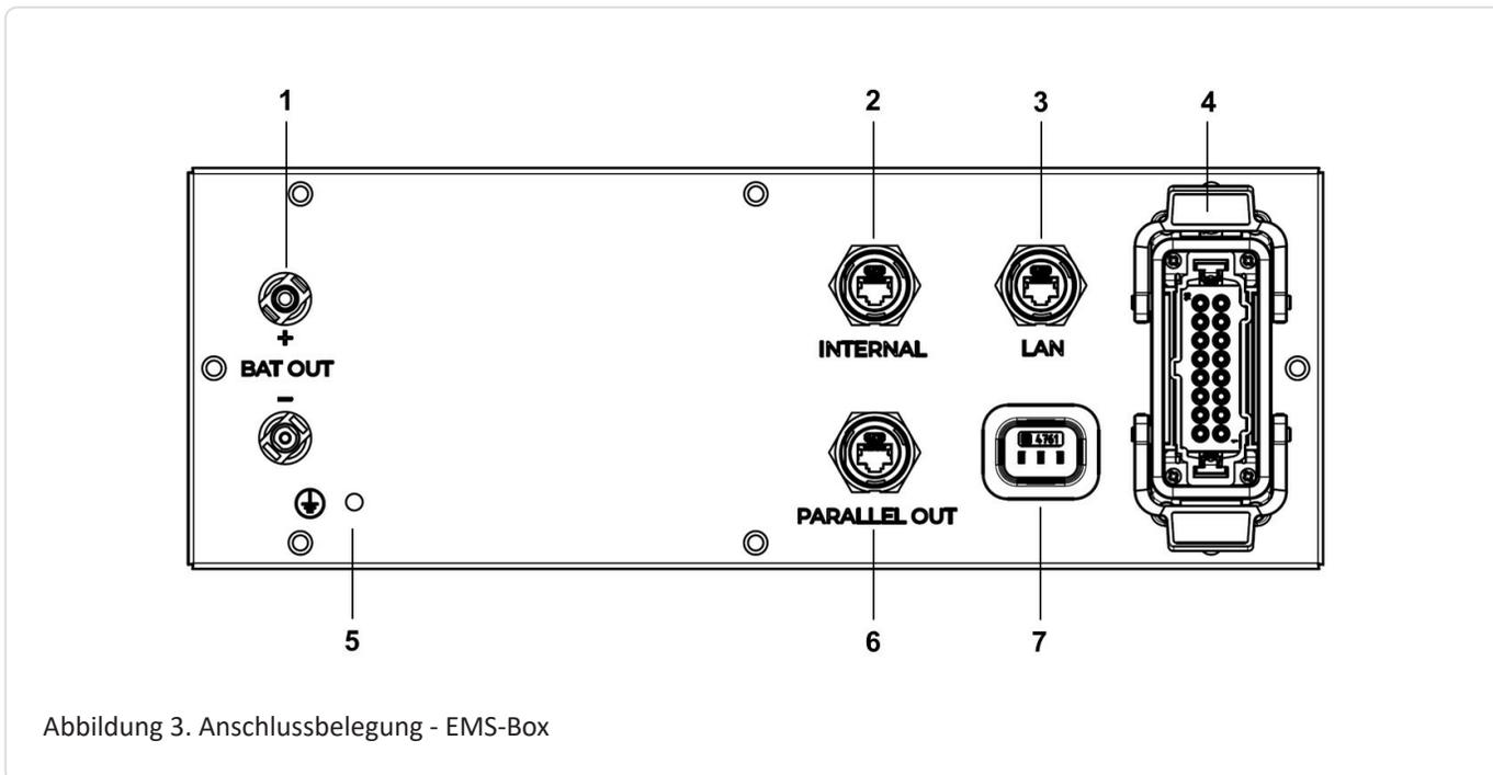
Abbildung 3. Anschlussbelegung - EMS-Box
