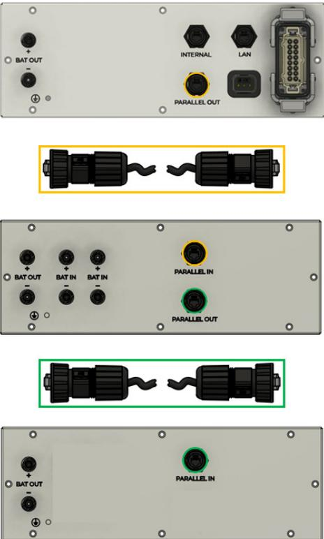
1. Wenn drei Batterietürme betrieben werden, dann müssen zwischen den drei Türmen die beiliegenden Netzkabel zwischen Turm 1 PARALLEL OUT und Turm 2 PARALLEL IN und zwischen Turm 2 PARALLEL OUT und Turm 3 PARALLEL IN gesteckt und verrigelt werden.
