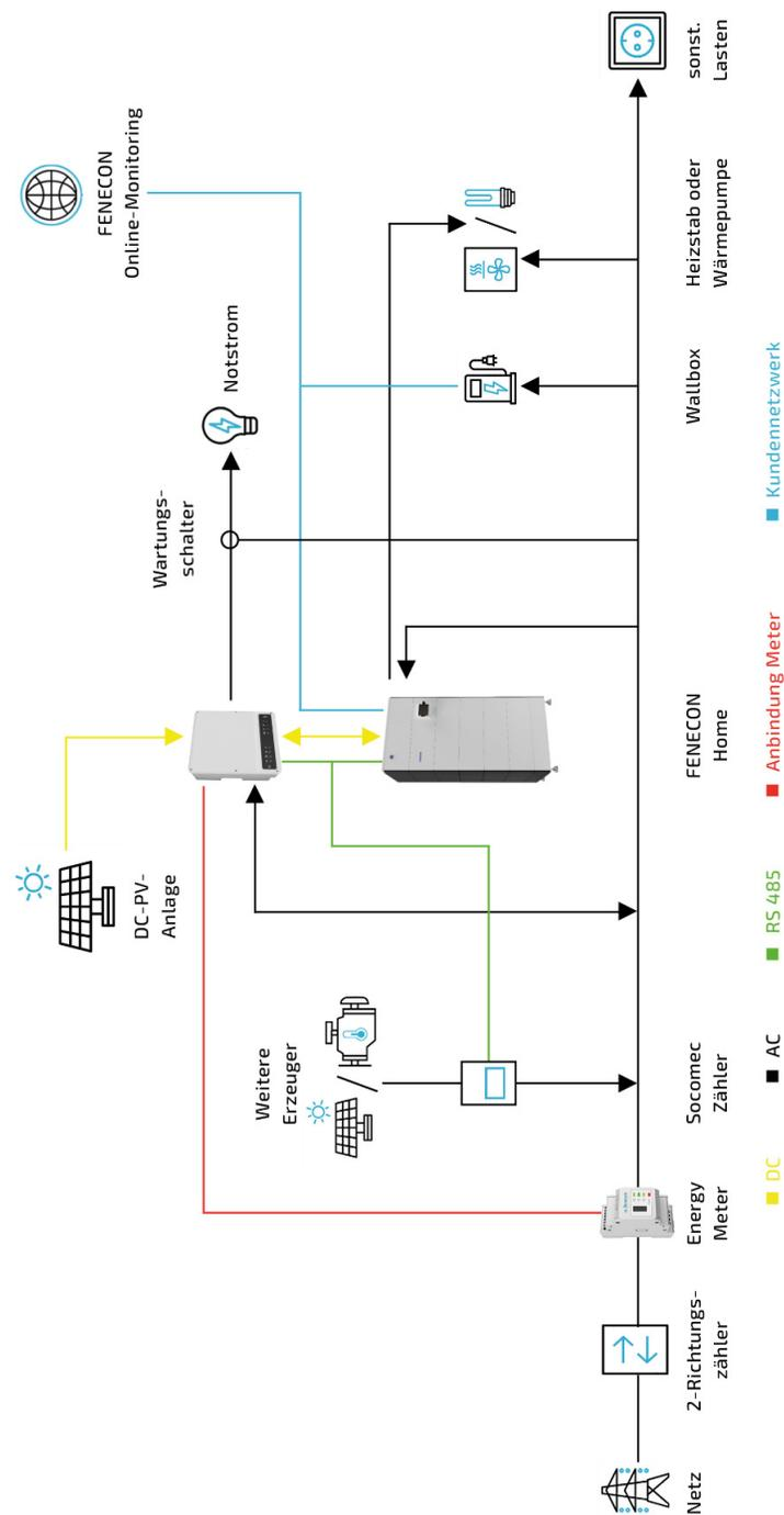
Abbildung 10. Anlage - schematische Darstellung mit optionalen Komponenten
