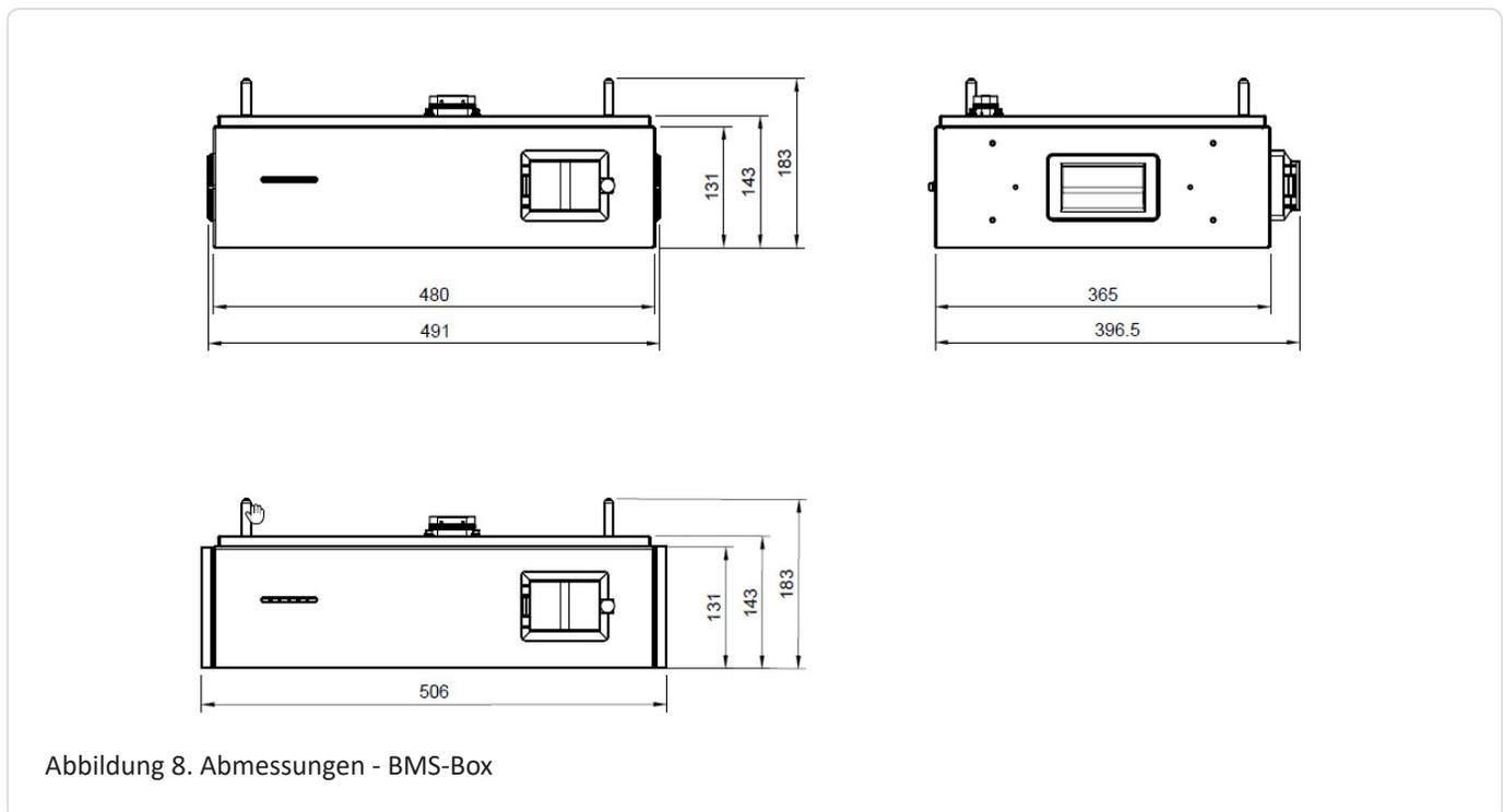
Abbildung 8. Abmessungen - BMS-Box
