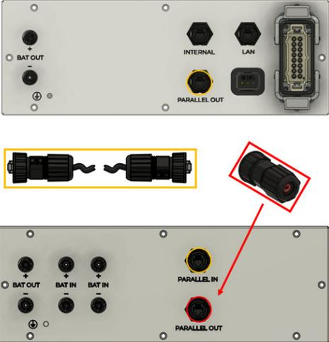
1. Wenn zwei Batterietürme betrieben werden, dann muss zwischen den beiden Türmen das beiliegende Netzkabel zwischen Turm 1 PARALLEL OUT und Turm 2 PARALLEL IN gesteckt und verriegelt werden.
